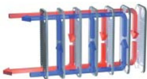
одноходовой – каналы соединены параллельно
