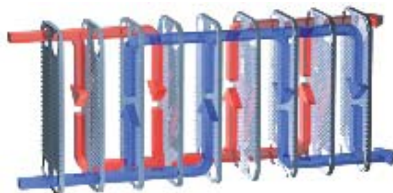
Многочеховой- система каналов разделённых на группы, которые соединены последовательно
